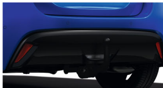
ANHÄNGEZUGVORRICHTUNG INKL. 13-POLIGEM E-SATZ
